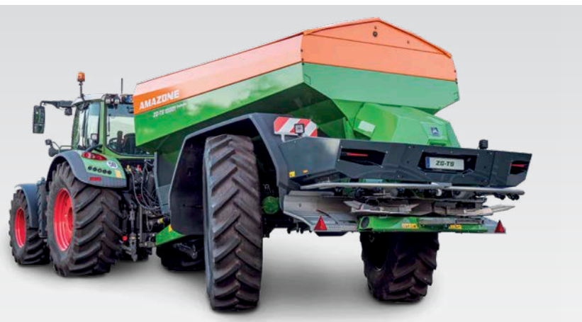
Oś skrętna z maks. 28° kątem skrętu
