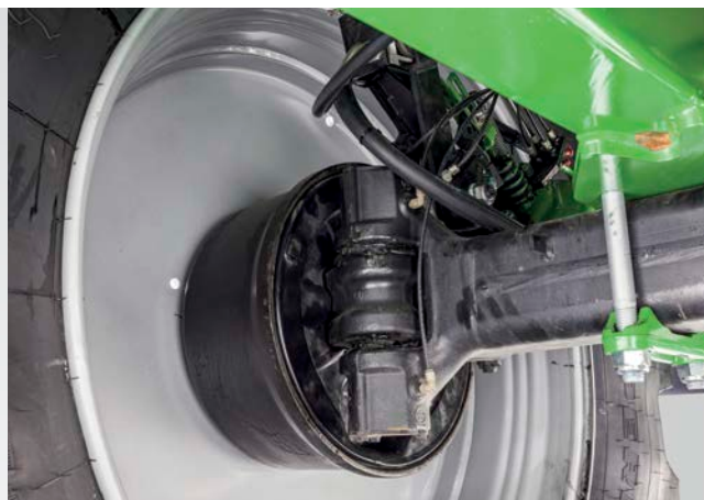
Regulacja siły hamowania za pomocą elektronicznego układu hamulcowego (EBS)
