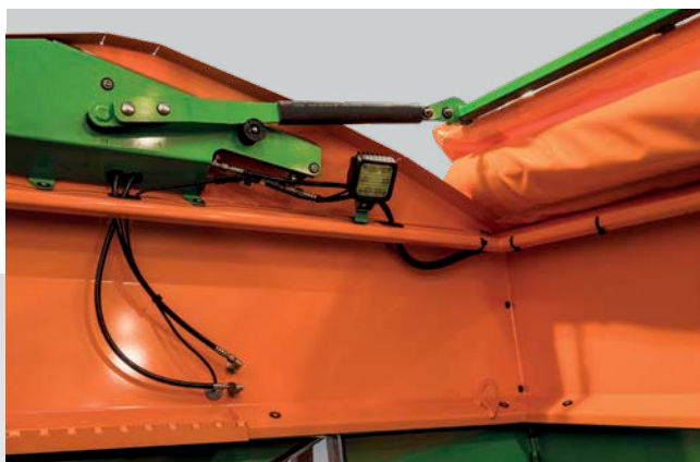
Oświetlenie robocze we wnętrzu zbiornika
