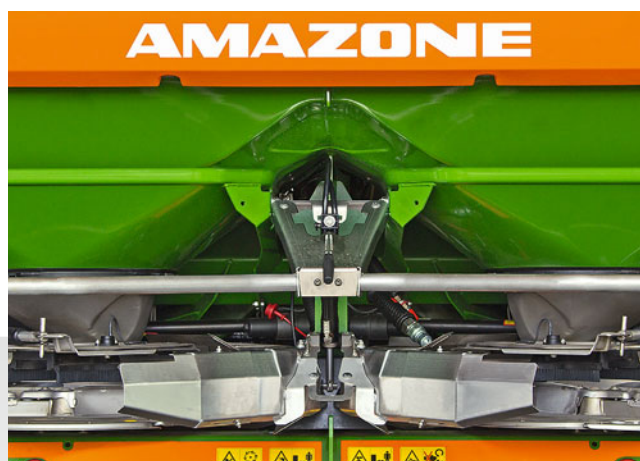
Obustronnie złożony ekran rozsiewu zagonowego z teleskopowymi końcówkami
