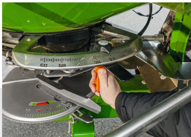
Proste przestawianie konsoli zasuw z dużą skalą
