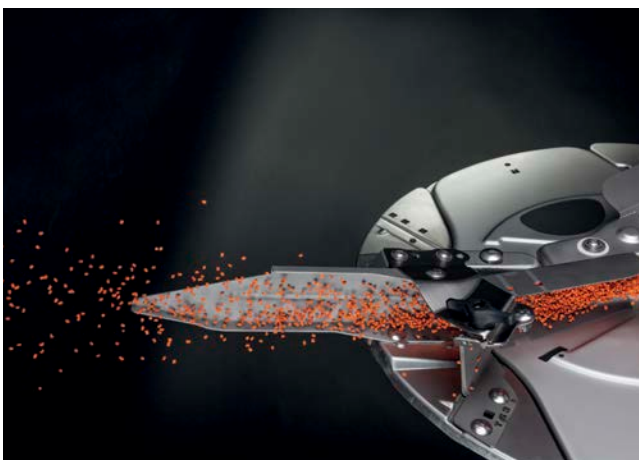
AutoTS – ustawienie do normalnego rozsiewu
