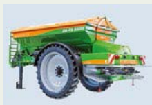
Rozsiewacz wielkopowierzchniowy ZG-TS 5500–8200 l, 18–54 m
