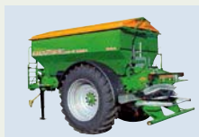
Rozsiewacz wielkopowierzchniowy ZG-B 5500–8200 l, 10–36 m
