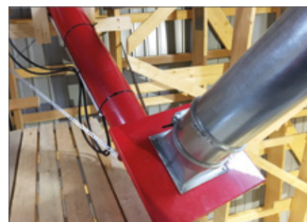
Silos lejowy / 160mm/200mm podłączenie rury do silosu lejowego
